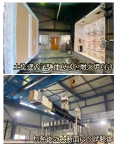
加熱後の大断面はり試験体
