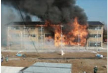
2012~2014年に、国土交通省「木造建築基準の高度化推進事業(早稲田大学・秋田県立大学・住友林業・三井ホーム・現代計画研究所・共同研究: 建築研究所)」の一環として、3度にわたり、木造3階建て校舎の実大火災実験にかかわる。安井・加来ともに、その後の木造防火分野への関わり方を変える契機となった実験。どのようにすれば、可燃物である木材を使いながらも、火災の進行をゆっくりとして、避難安全・延焼抑制・消防支援等を達成できるかを、実物の建物の燃え方を見て、感じて、考えた3年間となった。
